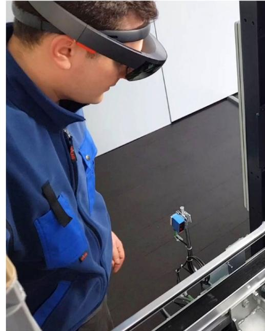
QR-Code ein, den wir mit dem Vuforia-Framework aus dem Video-Stream erkennen. Zusätzlich verwenden wir diesen Marker, um die initiale Position der Maschine zu präzisieren.
