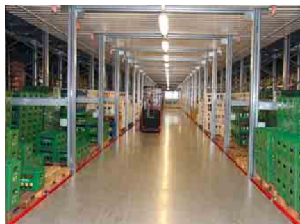
3 Im Kommissioniertunnel stellen die Mitarbeitenden, geführt mit Pick-by-Voice, die Kundenbestellungen auf Mischpaletten zu Auslieferungseinheiten zusammen
