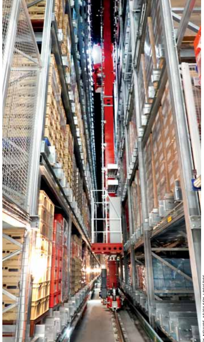
Die Produktlagerung erfolgt im vollautomatischen Hochregallager bei einer Temperatur von ca. -28 Grad Celsius.
