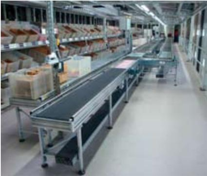
**Kommissionierbereich mit Pick-by-light-System; die Pickkanäle werden automatisch über das automatische Kleinteilelager beschickt.**
