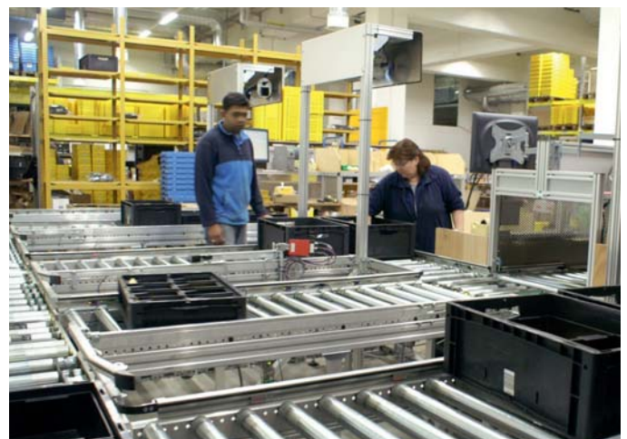
Intelligenter Fördertechnikkreislauf: rd. 500 Behälter werden pro Stunde ein- oder ausgelagert
