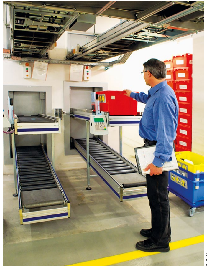
Auf der Krankenstation werden die Plastikbehälter mit der Ware entnommen, ihre Rückverfolgung wird mit RFID sichergestellt.
