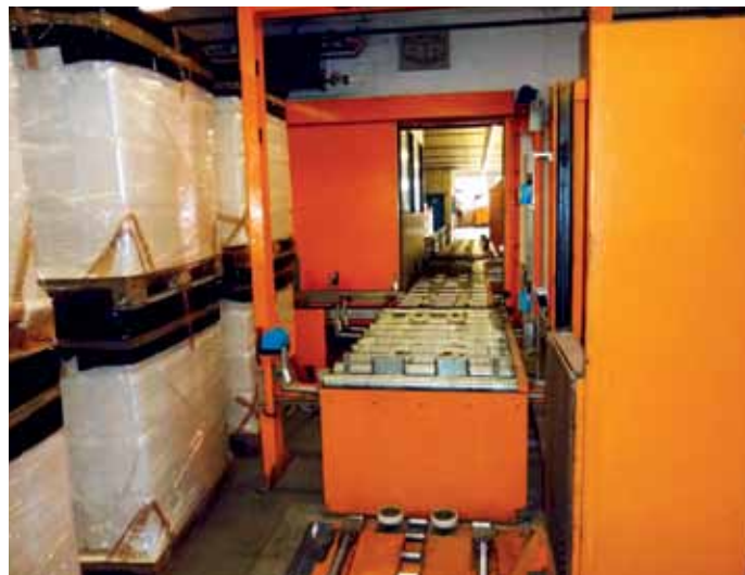
2 Auch die Sensorik und die Profilkontrollen der Horizontalfördertechnik inklusive des Verschiebewagens wurden modernisiert.
