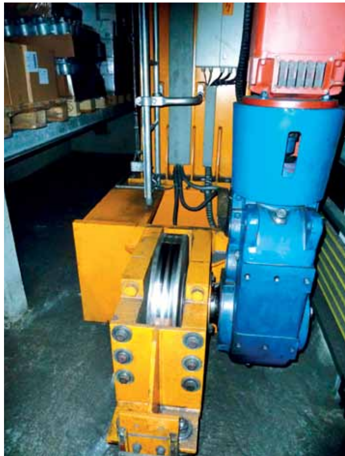
1 Erneuert wurde die Mechanik der Regalbediengeräte sowie deren Antriebs- und Positioniersysteme inklusive Sensorik und Elektroinstallation.
