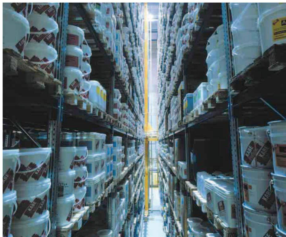
einer Höhe von 21 m und einer automatischen Palettenförderanlage realisiert. In der jüngeren Vergangenheit drohte die Verfügbarkeit dieser Anlage jedoch zusehends zu sinken. Wartung und Reparatur genügten nicht mehr, um die Betriebsunterbrechungen auf Grund von Störungen und Defekten auf das Maß einer Neuanlage zu reduzieren.
