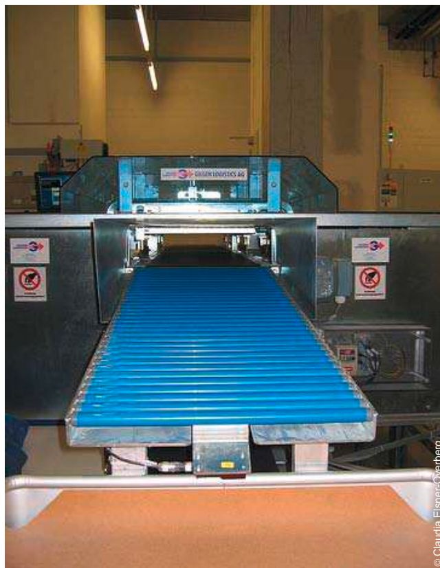
Buchtransportanlage von GilgenLogistik
