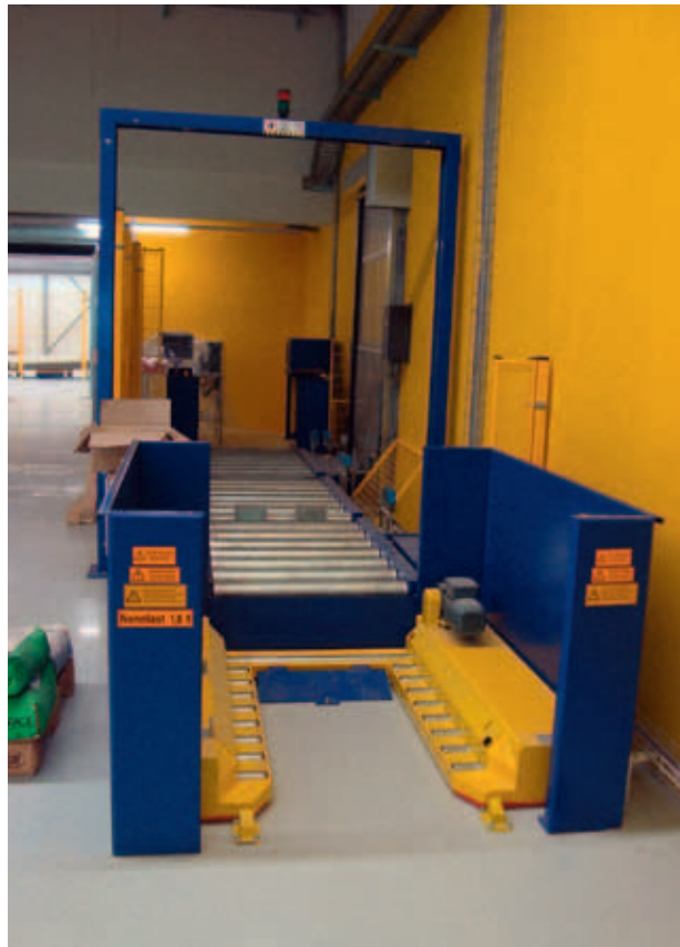
Einlagerung von Konfektionierung ins Hochregallager
