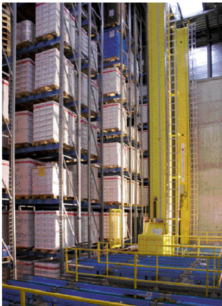
Durch die Erweiterung des Hochregallagers verfügen nun alle fünf Lagergassen über ein eigenes RBG
