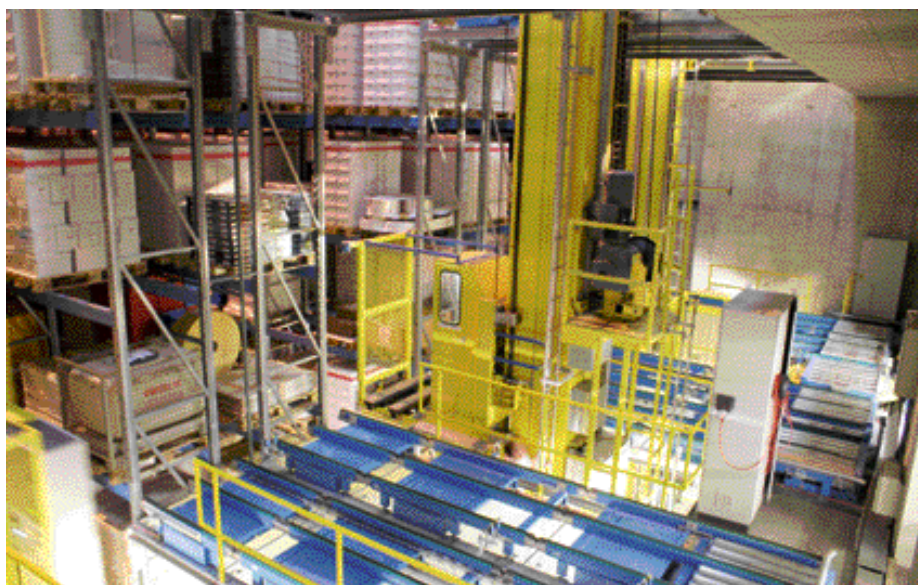
Eines der neuen Regalbediengeräte im Hochregallager von Seetal Elco
