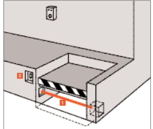
Überwachung des Zugangs zum Raum unter der Plattform.
