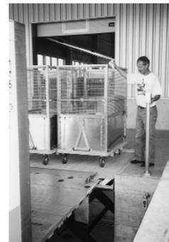
Dieser Bediener hat für das Heben und Absenken der Hebebühne eine gute Sicht.
