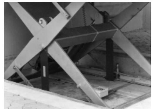
Bei ausgefahrenen Stützen ist das Instandhaltungspersonal gegen ein unbeabsichtigtes Absenken der Hebebühne geschützt.
