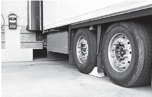
Bild 7: Mit Keil gesichertes Fahrzeug an einer Rampe
