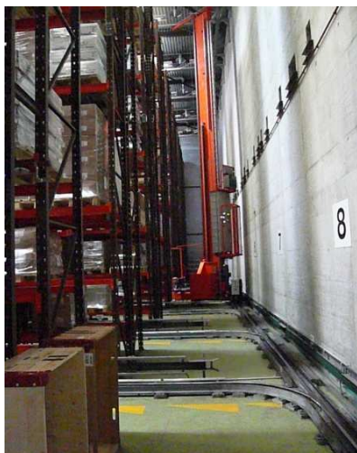
Bei den kurven- und weichengängigen Regalbediengeräten wurde die Antriebstechnik, sowie Steuerung und Software erneuert.
